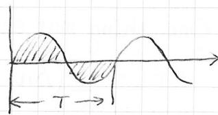
$$\vec{S} = \vec{E} \times \vec{H} \quad \vec{E} = \cos(kx - \omega t) \quad \vec{S} = \vec{E}_0 \times \vec{H}_0 = \cos^2(kx - \omega t) \quad \langle S \rangle = \frac{\int_0^T \vec{E}_0 \cdot \vec{H}_0 \cos^2(kx - \omega t) dt}{T}$$
